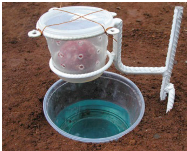
Figura 4. Armadilha de queda e dispositivo antipilhagem instalados.
