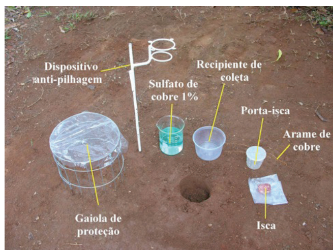
Figura 3. Componentes empregados na instalação da armadilha de queda com isca utilizando-se o dispositivo antipilhagem.
