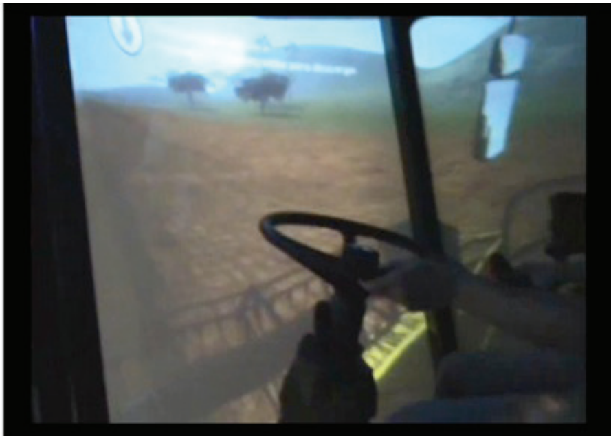
Figura 7. O simulador de colheitadeira da New Holland CR9060, que usa como cabine de colheitadeira real para oferecer uma interface mais realista.
