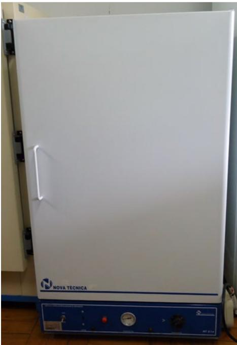
**Figura 66.** Estufa usada para secagem de insetos.
