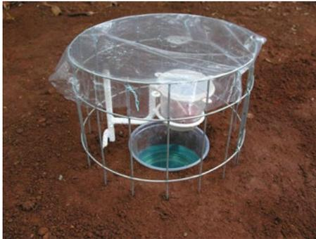
**Figura 25.** Armadilha de queda instalada com proteção.
