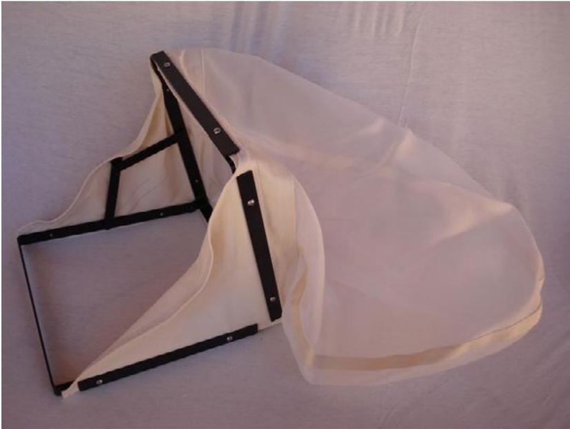
**Figura 53.** Fotografia de amostrador tipo *Surber*.
