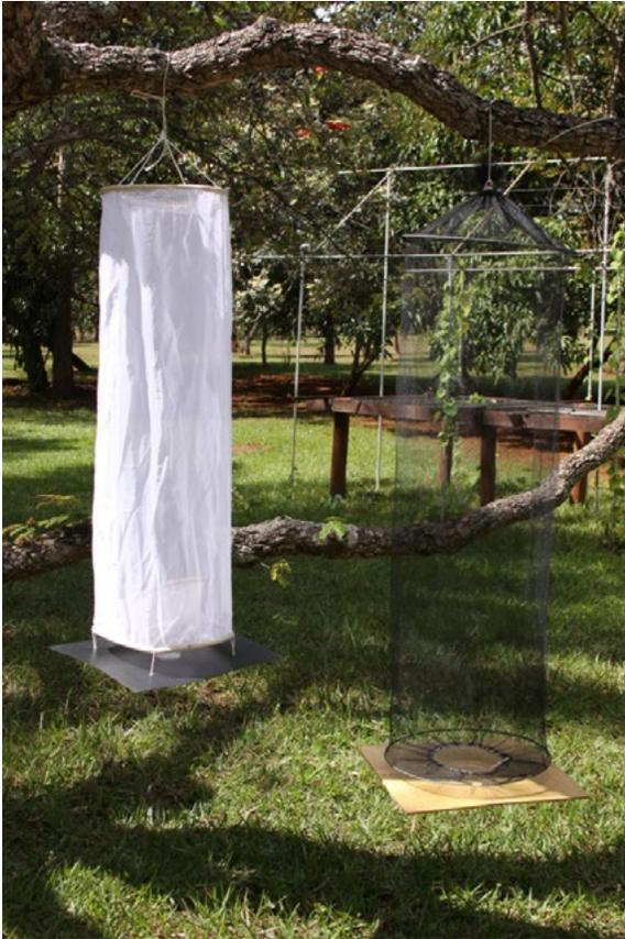
**Figura 22.** Armadilhas VSR: Van Someren-Rydon. (A) modelo MUP e (B) modelo OJM-F.
